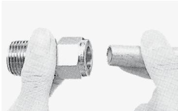
Das Rohr wird vorsichtig und leichtgängig bis zum Anschlag in die Verschraubung geschoben.
