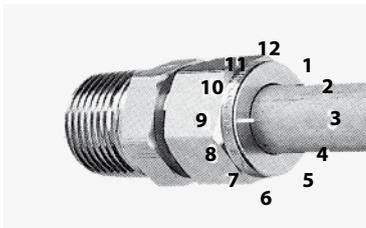
Stellen Sie sicher, dass die Mutter fingerfest angezogen ist, dann ziehen Sie die Mutter 1-1/4 Umdrehungen\* an. Halten Sie den Verschraubungskörper mit einem zweiten Schlüssel fest.
