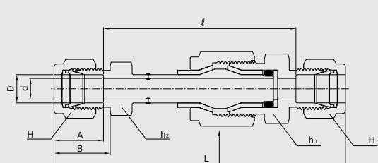
Achtung: Diese Sechskantverbindung nicht anziehen oder die Verbindung demontieren.
