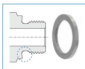
Zylindrisches ISO Rohrgewinde mit metallischer Dichtkante
