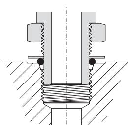
Zur Ausrichtung zurückgedrehte Verschraubung
