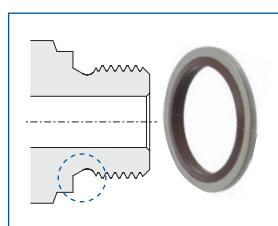
Zylindrisches ISO Rohrgewinde für Dichtscheibe
