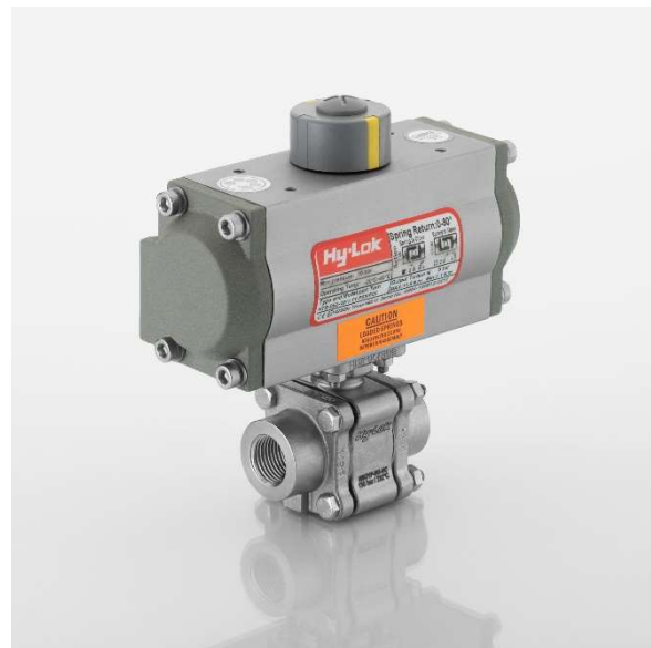
Kugelhahn Serie HSO mit Sitz aus RTFE und pneumatischem Schwenkantrieb
